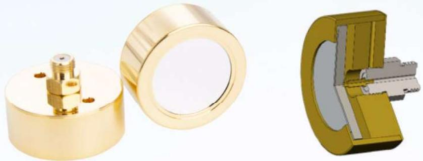
连续空气监测型表面钝化离子注入平面硅探测器 (CAM PIPS)，可用于对核设施内部和周围空气中的放射性粒子进行长期持续监测，探测器前窗表面溅射有铝层和保护涂层，铝层允许探测器在环境光照下操作，保护涂层使探测器可以在腐蚀性环境中正常使用。
